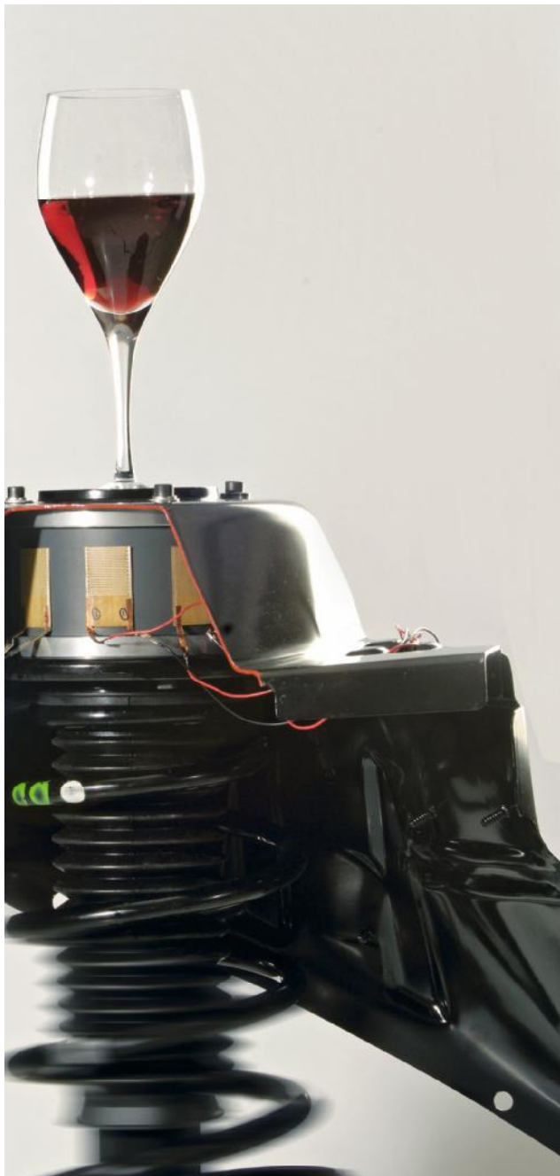
So erklären Fachleute der Adaptronik ihre Technik: Sie stellen das Glas Wein auf einen Resonator und lassen es vibrieren. Schalten sie nun den Regler der aktiven Schwingungskompensation ein, dann beruhigt sich der Wein im Glas auf der Stelle Bild: LBF
