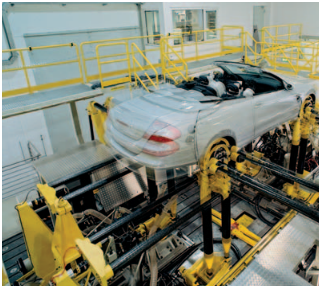
Bei Cabrios führt das fehlende Dach zu Steifigkeitsverlust. Gegenphasig induzierte Karoserieschwingungen könnten lästige Vibrationen beseitigen.
